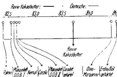
Die Zahlen bedeuten Skalenteile des Eintauch-Refraktometers. Zusammenfallende Werte sind durch Doppellinien bezeichnet.
